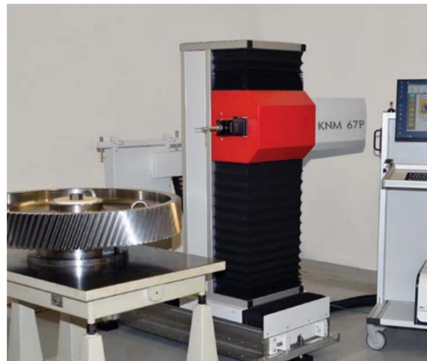
Die Geräte der KNM P Baureihe wurden auf die spezifischen Kundenanforderungen zur unabhängigen Messung von Verzahnungen, ringförmigen Werkstücken, wie z.B. Lagerringen, Gehäusen etc. direkt auf der Produktionsmaschine optimal angepasst.
