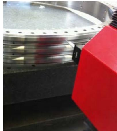
X- und Z-Achse aus Granit mit Luftlagerung, dadurch verschleißfreier Betrieb
